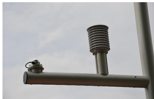
Sensori di temperatura dell'aria, umidità e radiazione globale
