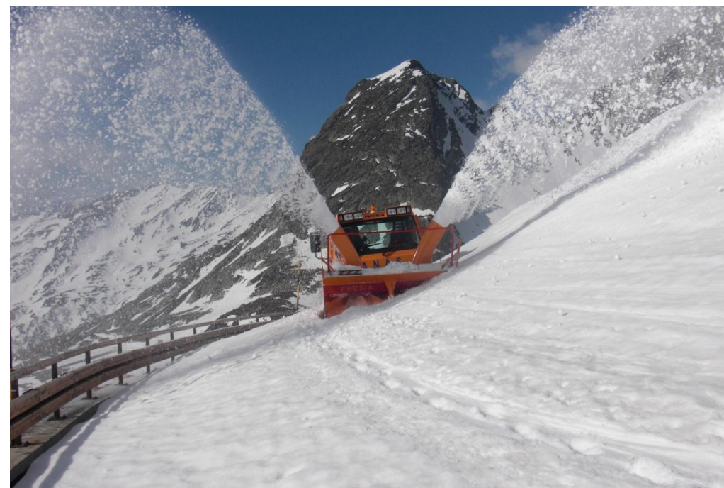
Fresa frontale – utilizzata per apertura
