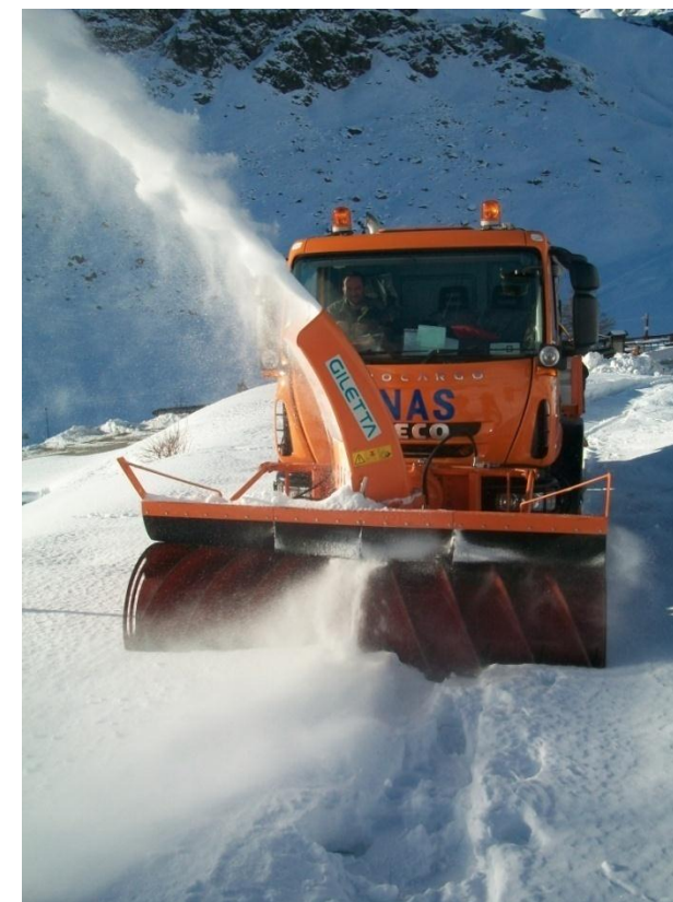
Fresa frontale – utilizzata per apertura
